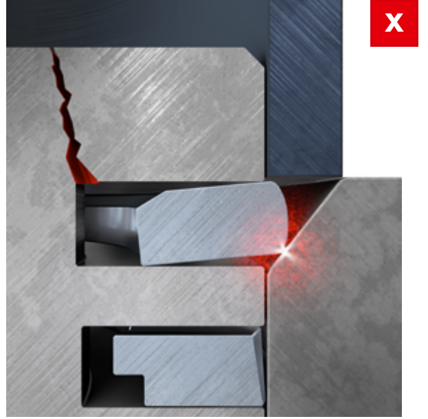
الشكل ١: الشطفة الكبيرة للغاية على فجوة الأسطوانة – تردد حلقة المكبس نابضياً عند التركيب بين شريط شد حلقة المكبس والأسطوانة وينغلق المكبس
