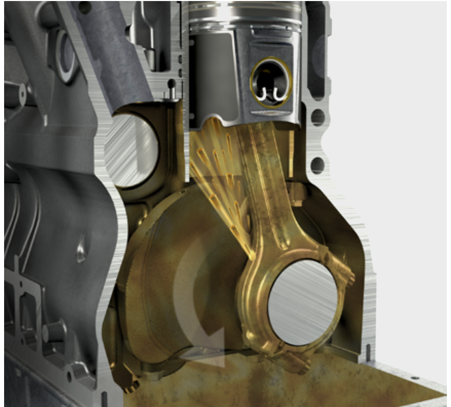
صورة ١: تقوب رش الزيت في ذراع المكبس تضمن تزليق سطح الحركة
