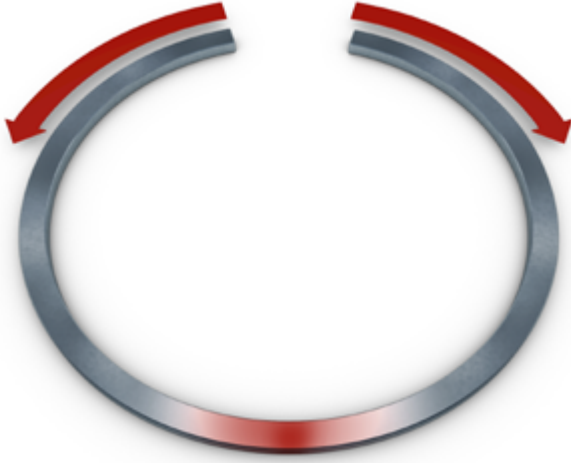
صورة ١: الانفراج المفرط في حلقة المكبس
