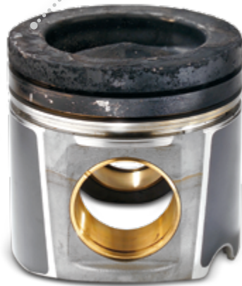
صورة ٣: طبقة زيت متفحم على سطح المكبس
