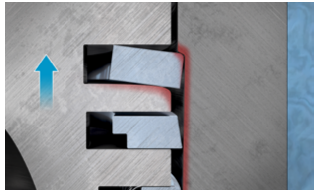
صورة ٢: اصطدام حافة حلقة المكبس في المكبس القديم
