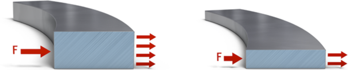
صورة ٢ وصورة ٣: شد الحلقة وقوة الكبس المخصوصة
