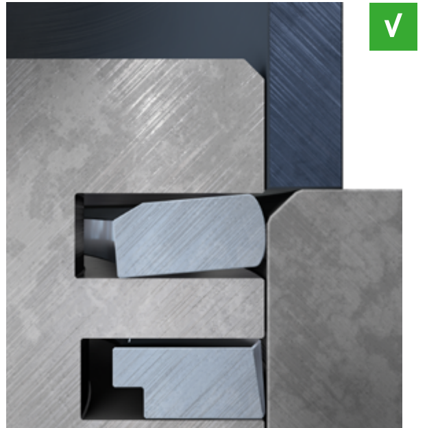
الشكل ٢: شطفة صغيرة على فجوة الأسطوانة – حلقة المكبس تنزلق عبر الفجوة
