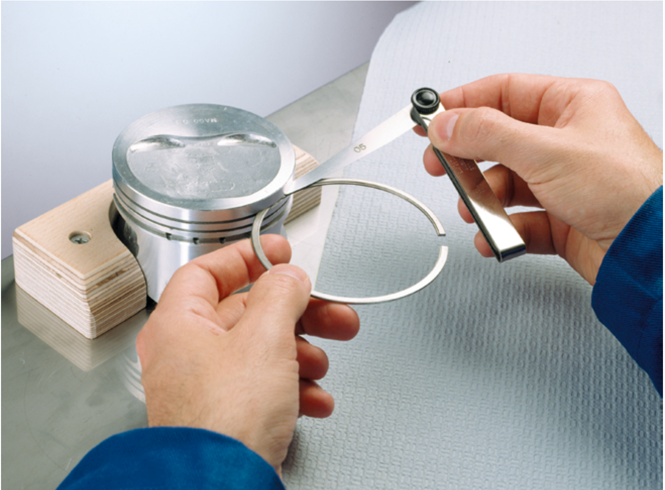
صورة ١: قياس شوط ارتفاع الحلقة
