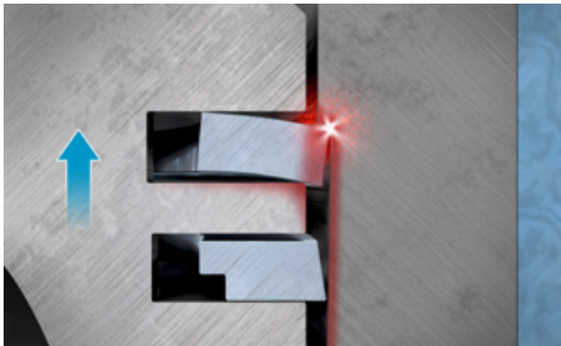
صورة ٣: اصطدام حافة حلقة المكبس في المكبس الجديد
