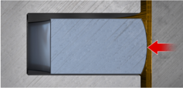
صورة ٢: سطح دوران الحلقة متمثل التكور
