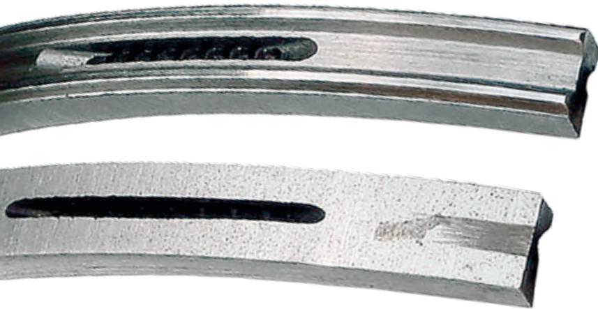
الشكل ٣: حلقة إزالة زيت جديدة ومتآكلة
