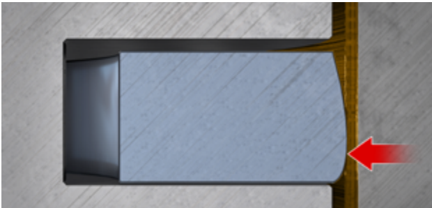
صورة ٣: سطح دوران الحلقة غير متمثل التكور
